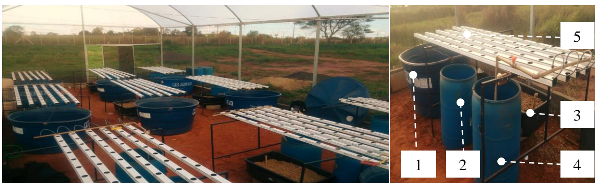
Figura 1. Arranjo espacial de baterias de sistema aquapônico Nutrient Film Technique (NFT): (1) viveiro de criação de animais aquáticos; (2) tanque de decantação de sólidos orgânicos; (3) caixa de filtração e desnitrificação bacterianas; (4) reservatório de recirculação d'água; (5) módulo hidropônico. The spatial arrangement of the Nutrient Film Technique (NFT) aquaponics system: (1) aquatic animal nursery; (2) decantation tank for organic solids; (3) bacterial filtration and denitrification box; (4) water recirculation tank; (5) hydroponic module.
